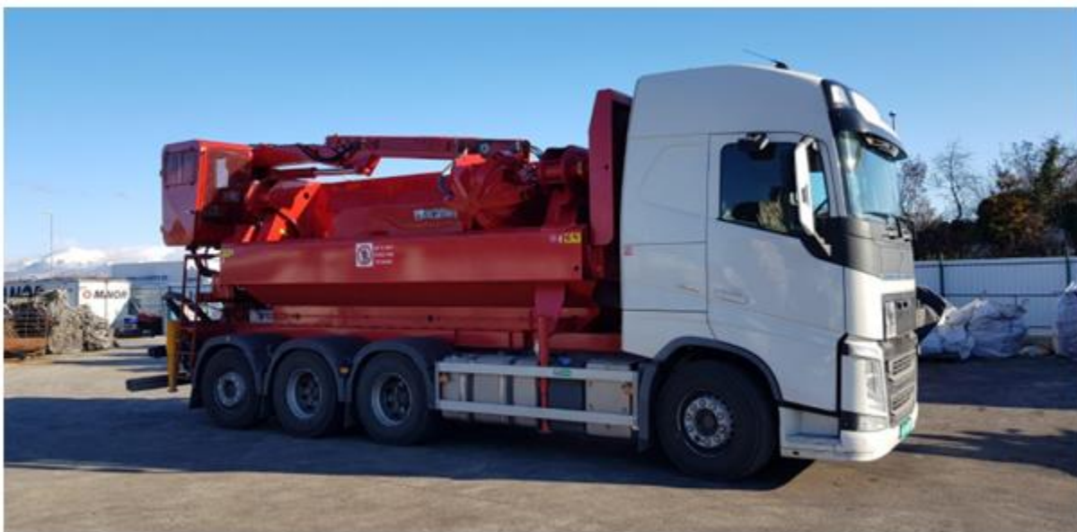
Slika 10. Izgled mobilne prese za deformisanje metalnih limova postavljena na kamionsku šasiju
