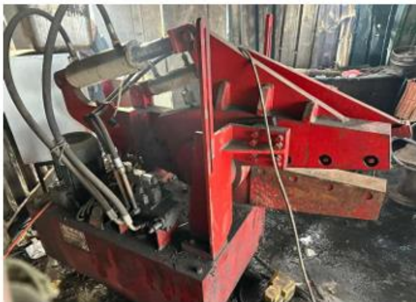
Slika 8. Elektrohidraulične makaze za sječenje metalnog neopasnog otpada
