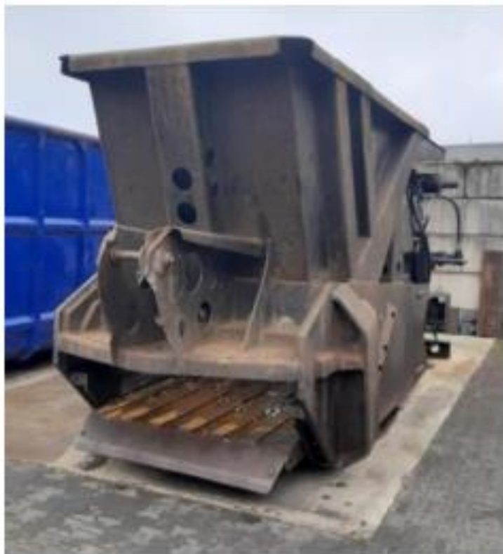
Slika 11. Prikaz mobilnih makaza za sječenje i usitnjavanje habastih metalnih limova
