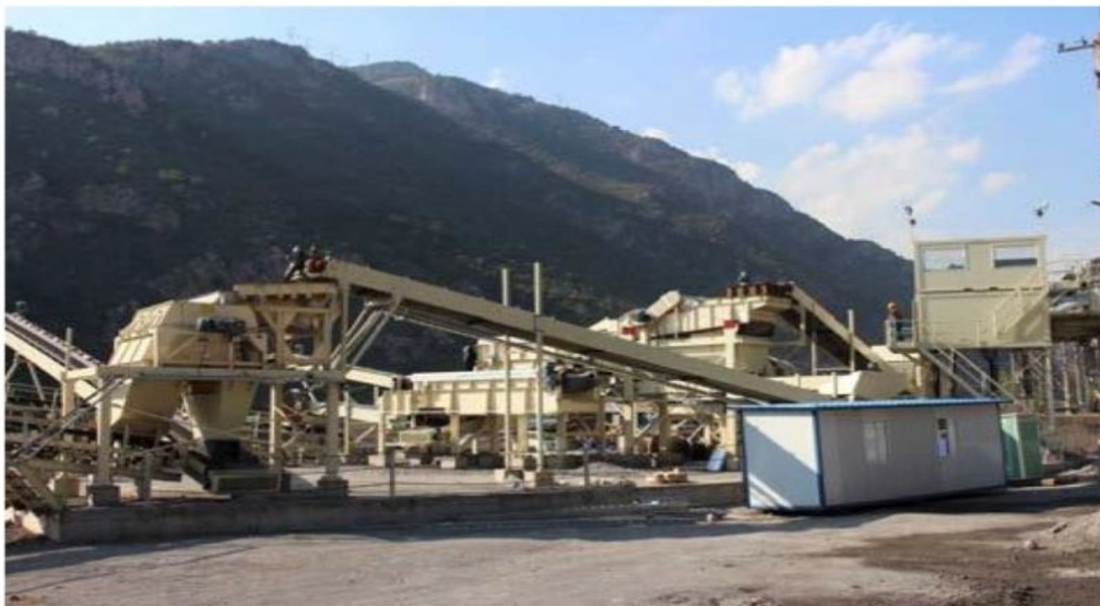
Sl. 3.a.1. Postrojenje za preradu šljake i preradu gvozdeno-metalnih materijala – Addforce SLAG2GREEN
