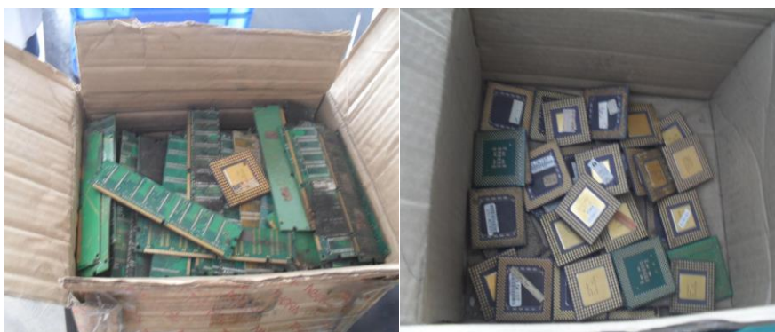
Slika 14. Djelovi otpadne elektronske opreme pogodni za izdvajanje plemenitih metala
