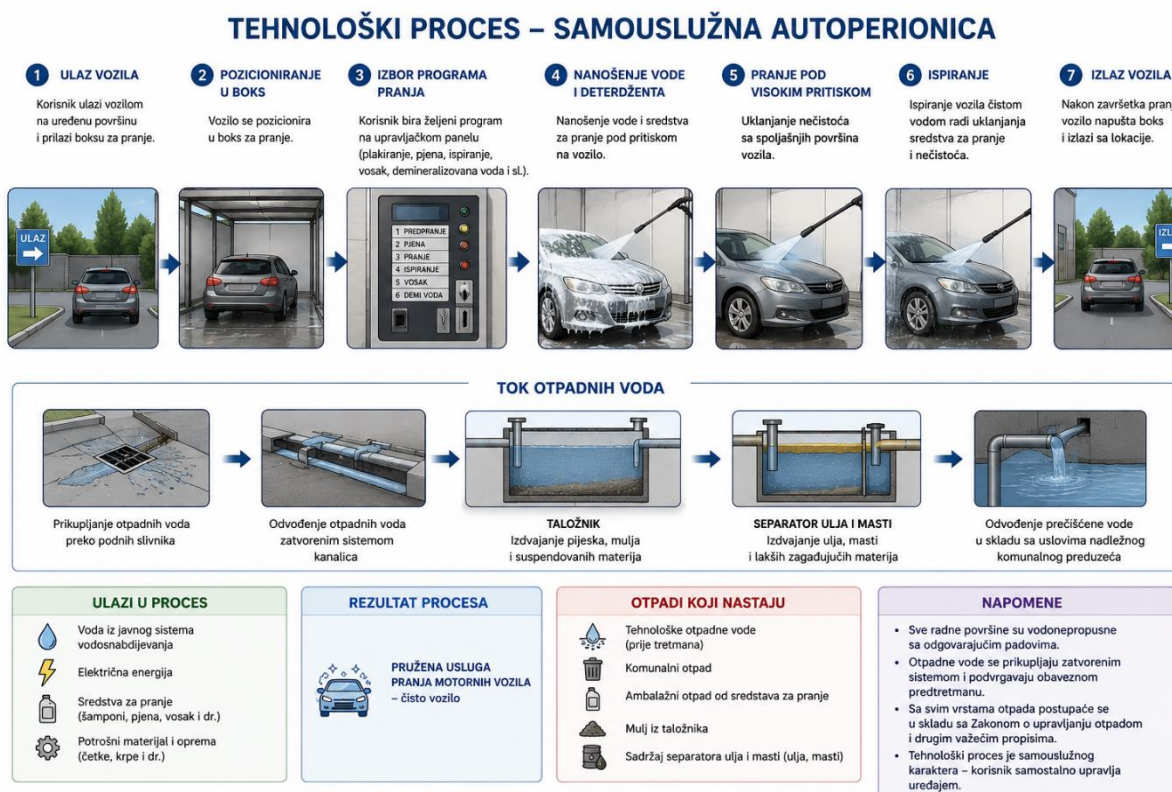
Slika 3.3.1. Tehnološki proces rada samouslužne autoperionice
