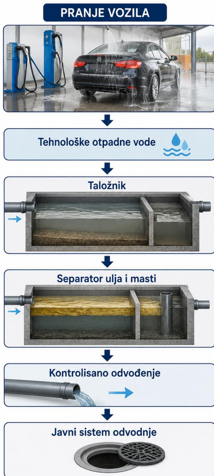
Slika 3.3.2. Šematski prikaz toka tehnoloških otpadnih voda (pranje → taložnik → separator ulja i masti → javna kanalizaciona mreža).
