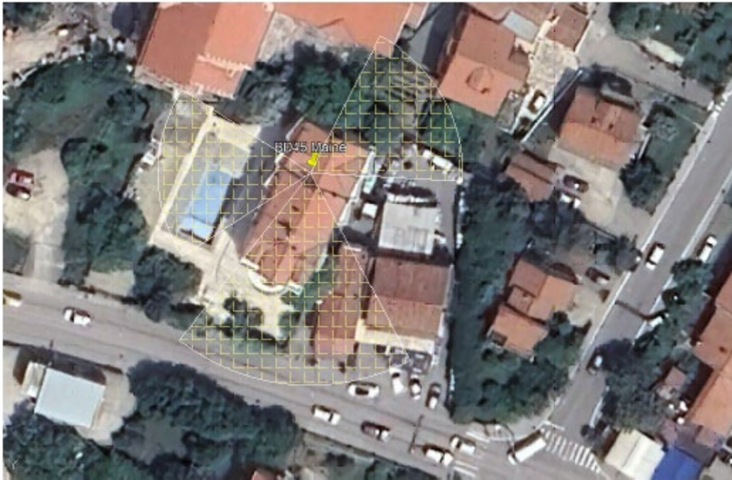
Slika 3. Pozicija antenskih nosača na objektu sa prikazanim azimutima antena, graničnom zonom i okolnim objektima
