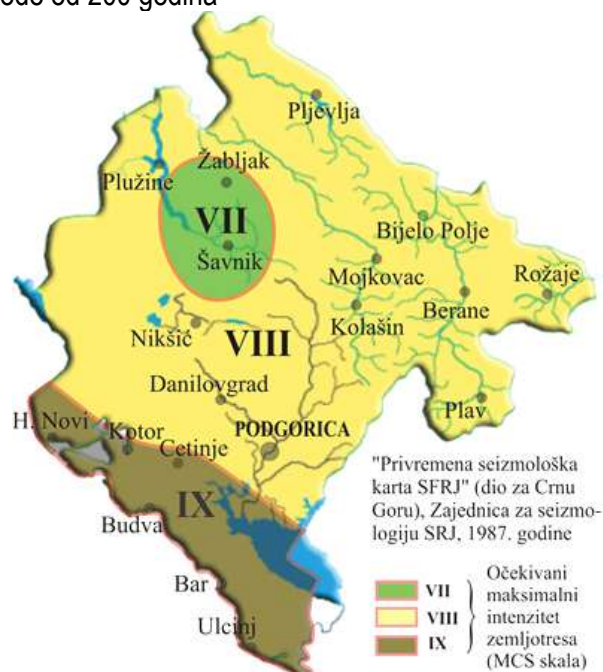
grafički prikaz 16: Privremena seizmološka karta SFRJ (dio za Crnu Goru) sa nivoima očekivanog maksimalnog intenziteta zemljotresa za povratni period od 500 godina (1987)
