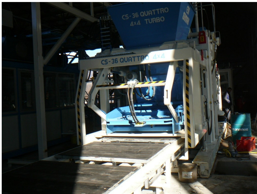
Slika 29. Mašina za presovanje materijala u kalupe
