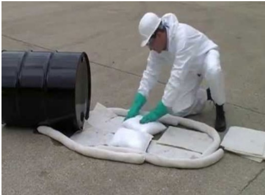
Slika 6-1: Apsorbenti (jastučići i brane) za upijanje uljnih materija
