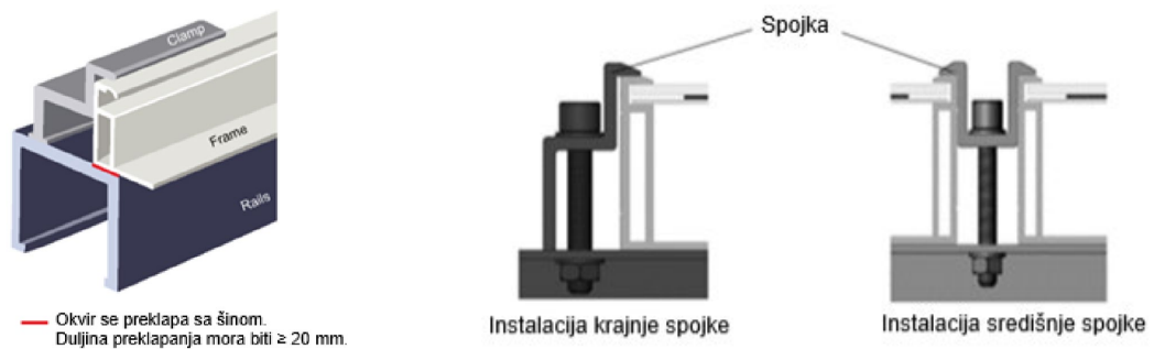
Slika 62: Instalacija vijaka i spojki
