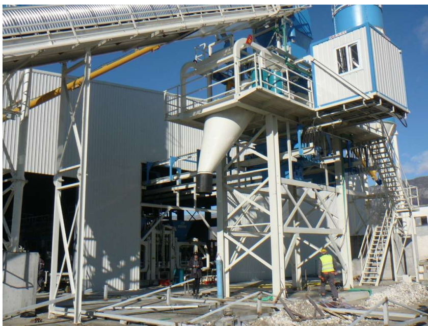
Slika 28. Mješalica za miješanje komponenti za proizvodnju betonskih elemenata
