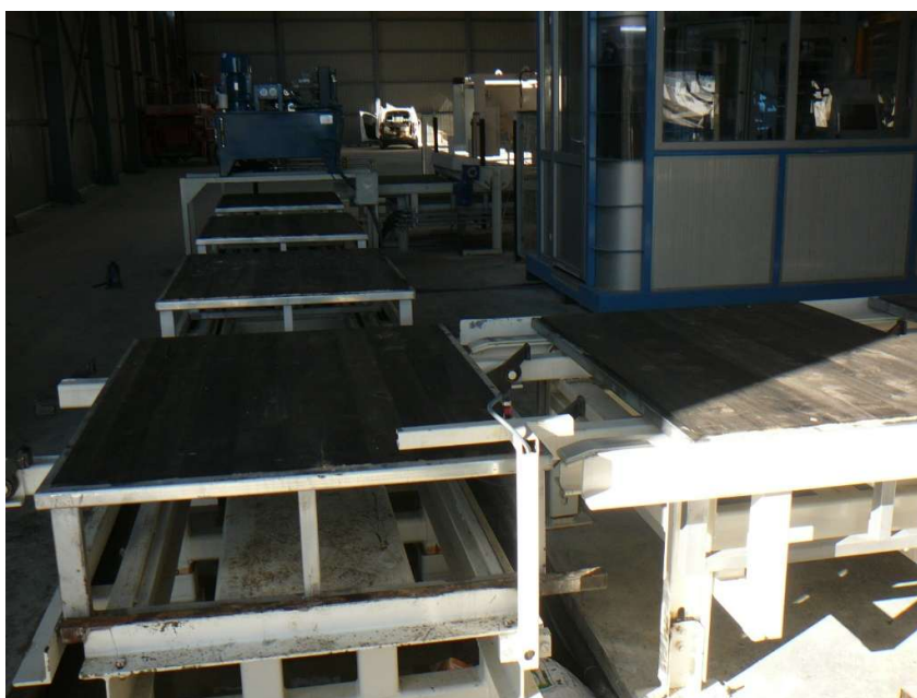
Slika 30. Linija za transport kalupa sa presovanim materijalom
