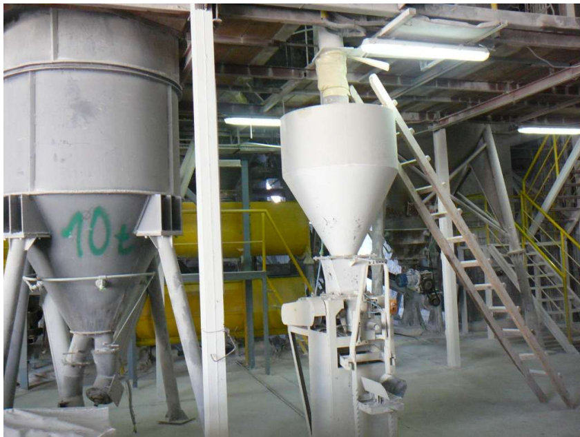
Slika 20. Silos za cement i kreč
