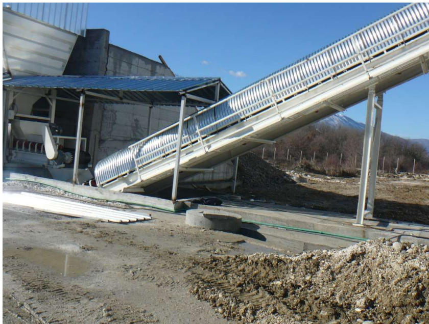
Slika 27. Transporter za transport granulata 0-4 mm do mješalice
