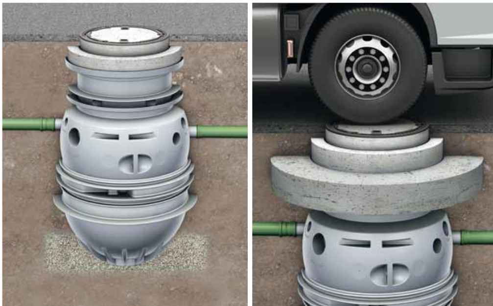
Slika 3-10 ACO separatori lakih naftnih derivata za ugradnju u zemljište
