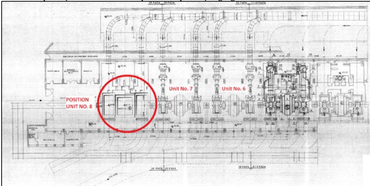
U okviru do sada urađenih analiza i studija pokazalo se da je za poboljšanje uslova rada elektrane sa osmim agregatom, dakle sa ukupnim protokom 81,75 m<sup>3</sup>/s, neophodno izvesti rekonstrukciju postojeće odvodne vade za Agregat A8, rekonstrukciju čvorišta kanala Zeta I - kompezungioni bazen - ulazna građevina kao i dogradnju vodostana.
