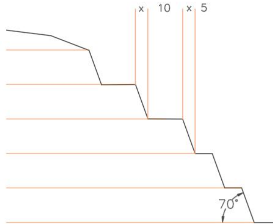
Slika 10. Konstruktivni parametri površinskog kopa „Milošev Krš“
