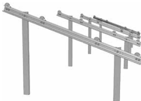
Slika 3.23. Sistem vezivanja na potkonstrukciji
