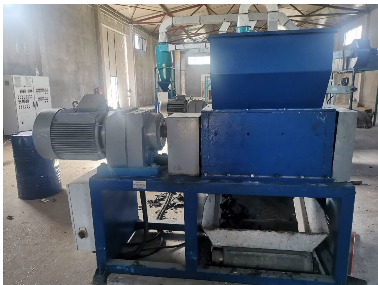
Slika 3.8. Mlin u koji se ubacuje guma nakon sečenja i izvlačenja žice
