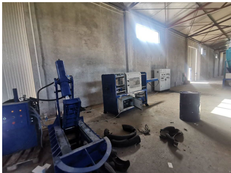
Slika 3.7. Sa lijeve strane giljotina, zatim hidraulična mašina za izvlačenje žice i komandni pult
