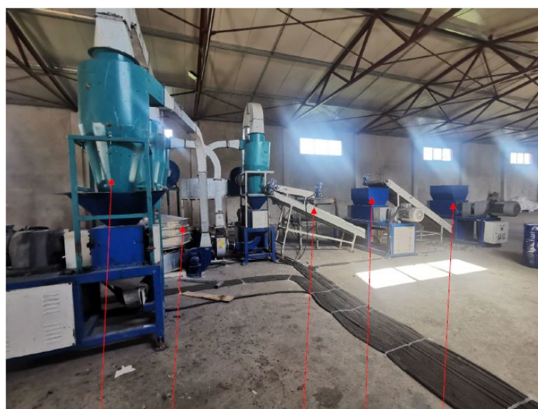
4 ciklona sito magnetna traka mlin 2 mlin 1
