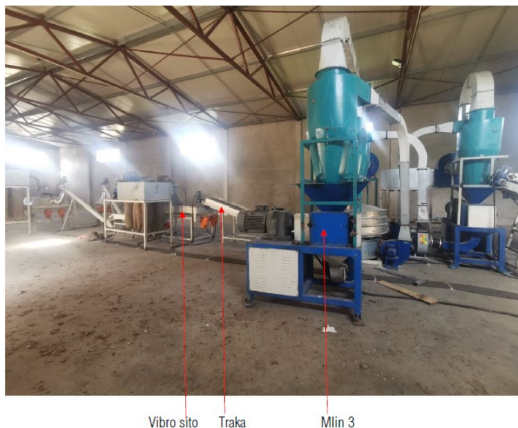
Slika 3.10. Izgled linije za reciklažu od sita do izlaznog dijela gotovog proizvoda
