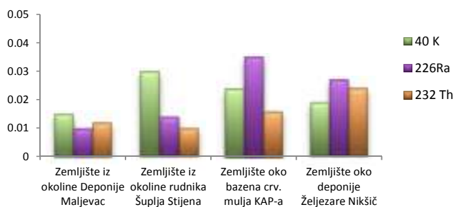
Grafikon 95. Efektivna doza izražena u mSv, posledica uticaja 40 K, 226 Ra, 232 Th iz zemljišta-otvoreni prostor za 2010 god.
