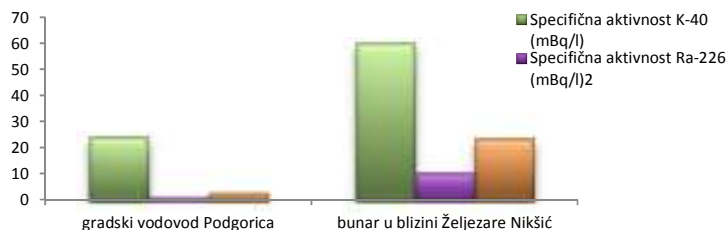
Grafikon 103. Poređenje srednjih vrijednosti koncentracija radionuklida (mBq/l) mjerenih u vodi za piće iz gradskog vodovoda Podgorica i u bunaru u blizini deponije Željezare Nikšić tokom 2010. godine
