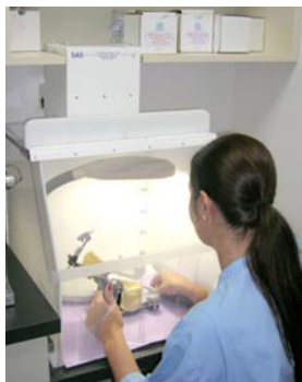
Slika 1.4 Primjer hemijske ventilacione komore
