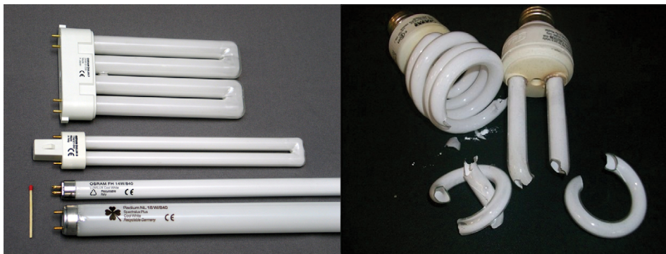
Slika 2.2 Kompaktne fluorescentne sijalice i cijevi i primjeri oštećenja
